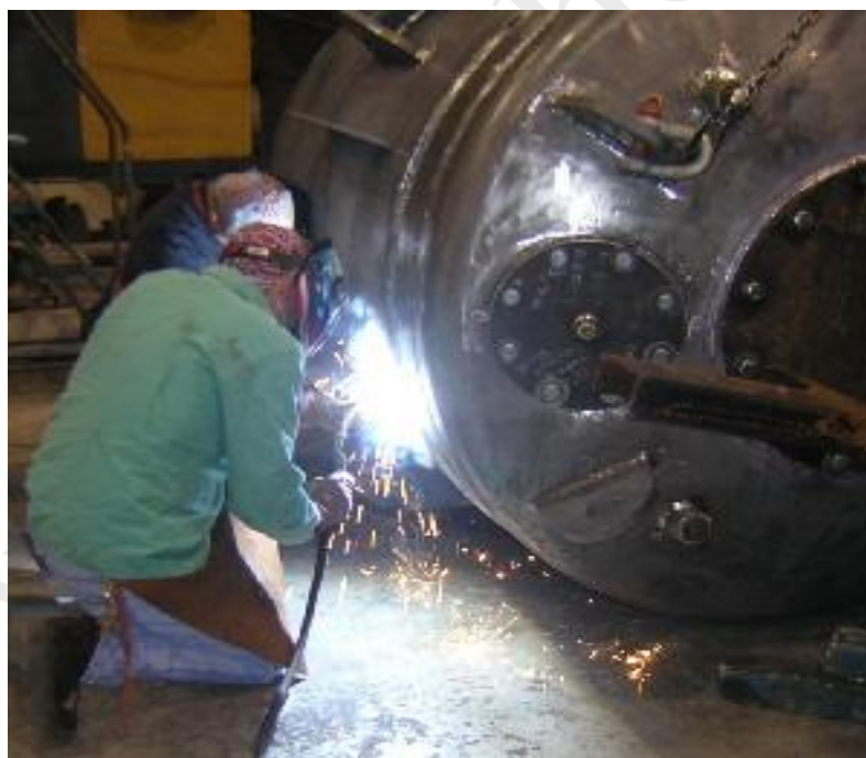
شکل ۱-۱: روش جوشکاری در ساخت مخازن
